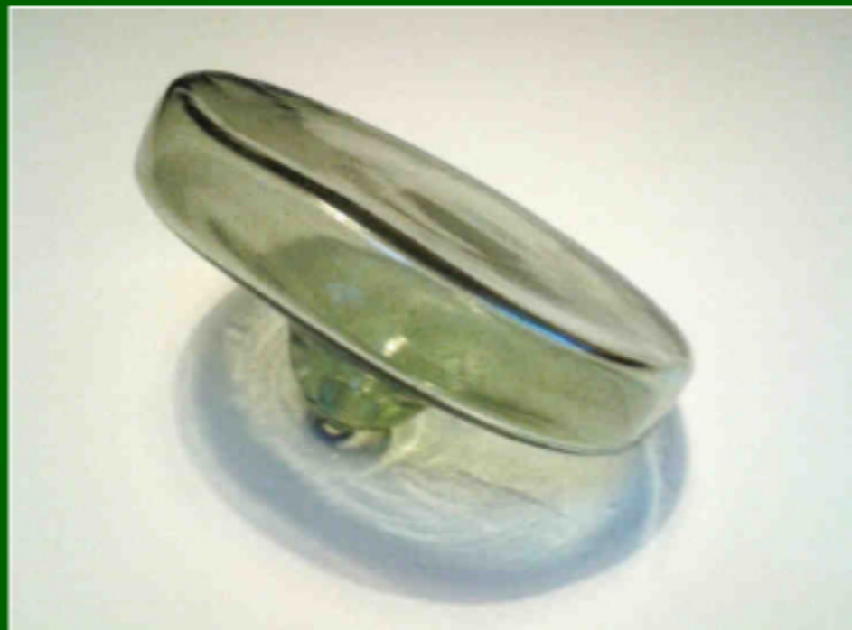
Obr. 24: měsíční sklo, polotovar vyfouknutého tvaru před opuknutím dna.
